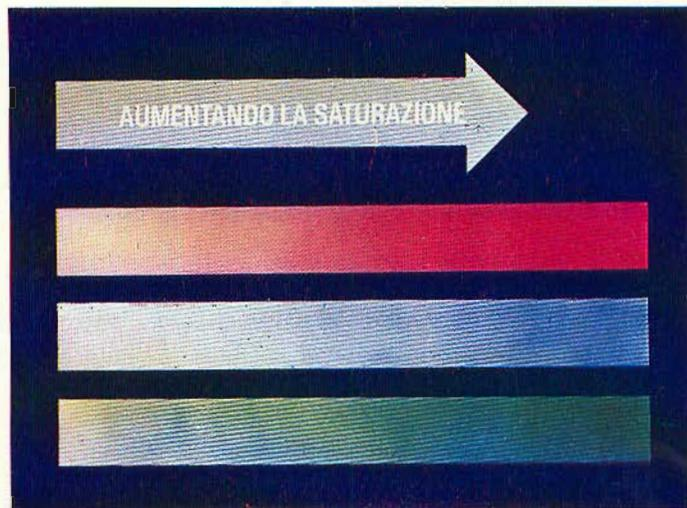
Fig. 5 - È un altro esempio che mette in evidenza quando delle tre caratteristiche dei tre colori fondamentali (rosso, verde e blu) si varia solo la saturazione.
