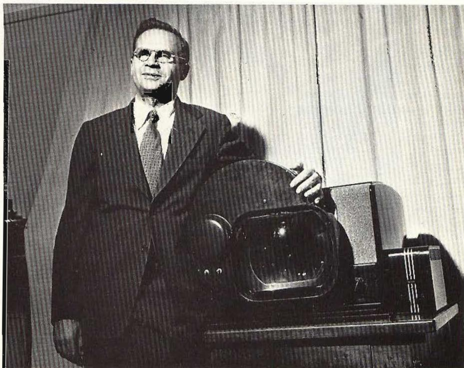
Fig. 2/B - Il Dr. Goldmark posa con un ricevitore TVC sequenziale nei primi mesi del 1950.
